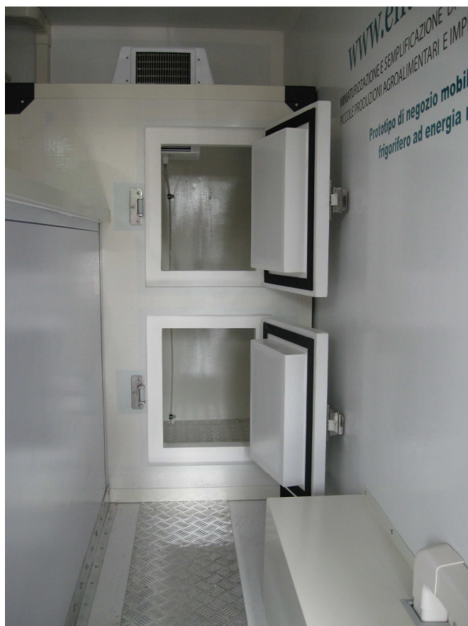
Figura 5 - Cella frigorifera installata nel negozio mobile.
